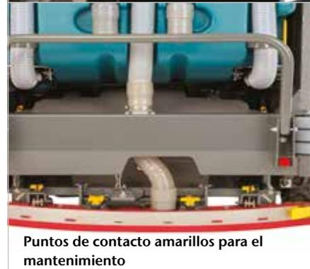
Puntos de contacto amarillos para el mantenimiento
